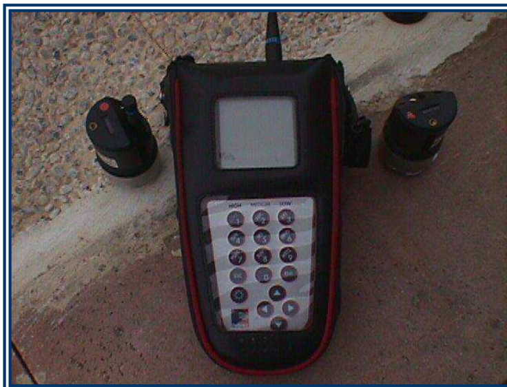
Aspecto de unidad receptora "Patrullador" y dos unidades de registro "Permalog".
